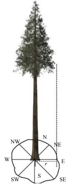
图 1 树冠半径测量示意图
